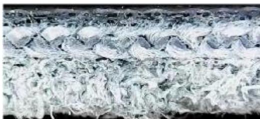
a) 动物纤维复合全层皮革横截面高倍显微镜图
